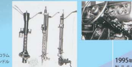
1998年 製品名:コストハーフコラム 安価で高剛性な一体ジャケットのステアリングコラム 開放コークを新規採用
