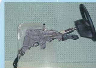
1996年 製品名:水方向EAコラム 北米での安全基準を満足するため開発した水方向 衝撃吸収ステアリングコラム
