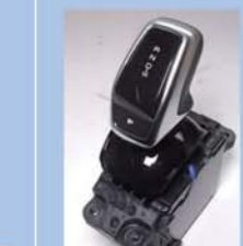
2021年 製品名:電制A/Tシフター (シフトバイワイヤ) 本体:ECU付きノブ ポジションインジケータ機能付き
