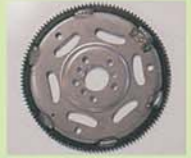
2013年 製品名:ドライブプレート 音質低減、備芯回転構造、プレート SPFH590、t2.3材を初採用 アンバランスウェイト付加
