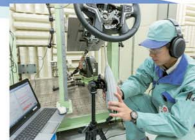
異音の調査(大型反響室)
