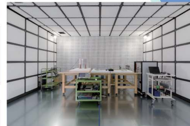
電波暗室(電子部品評価の実験室)
