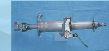
1998年 製品名:コストハーフコラム 安価で高剛性な一体ジャケットのステアリングコラム 開放コークを新規採用
