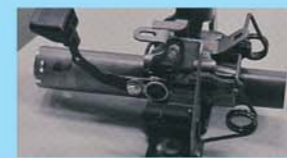
2008年 製品名:多版ロック式チルトテレスコラム 保持性能を大幅に向上。多版ロック式 チルト&テレスコピック機構
