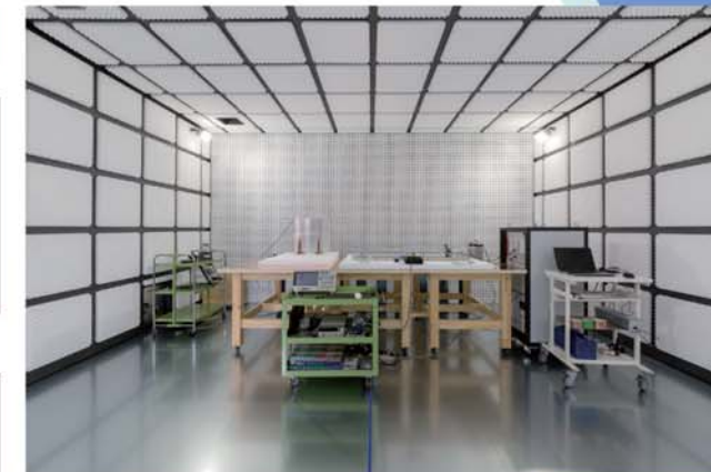
電波暗室(電子部品評価の実験室)
